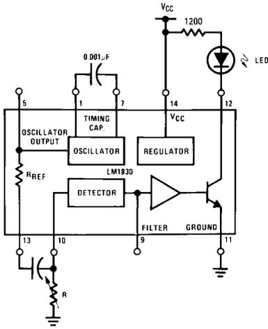
**FIGURE 1. Test Circuit**
